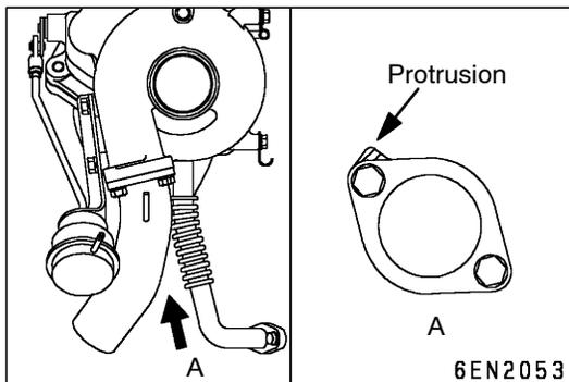
**►C◄ AIR OUTLET FITTING GASKET**
