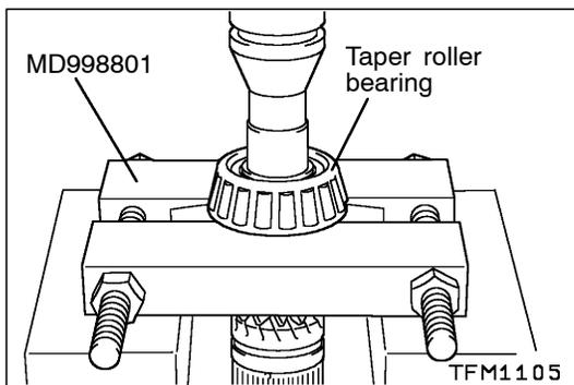
◀G▶ TAPER ROLLER BEARING REMOVAL
