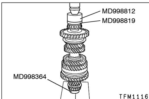
►O◄ TAPER ROLLER BEARING INSTALLATION
