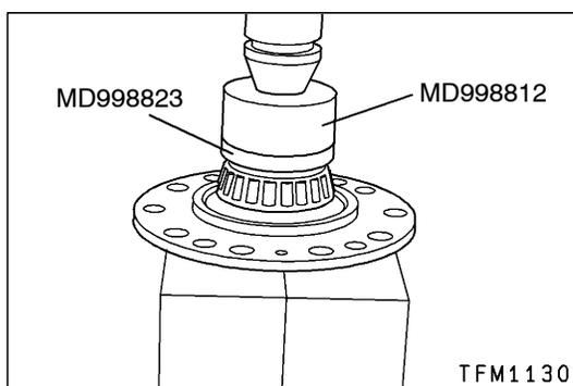
**▶B◀ TAPER ROLLER BEARING INSTALLATION**
