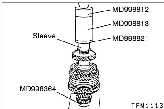
►K◄ 5TH SPEED GEAR SLEEVE INSTALLATION
