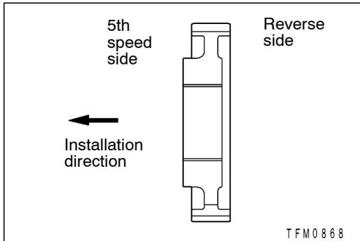
►M◄ 5TH-REVERSE SPEED SYNCHRONIZER HUB INSTALLATION
