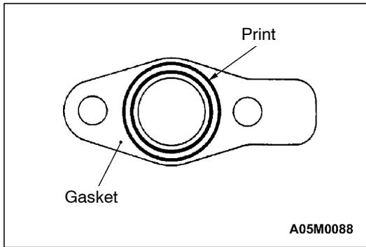
►◀ OIL RETURN PIPE GASKET INSTALLATION
