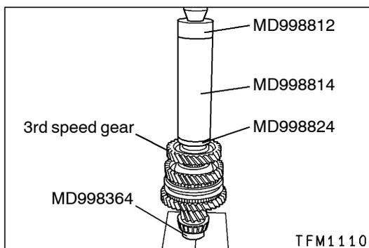
►H◄ 3RD SPEED GEAR INSTALLATION
