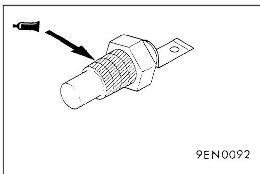
**▶C◀ ENGINE COOLANT TEMPERATURE GAUGE UNIT INSTALLATION**
