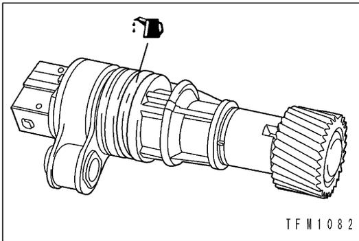
**▶H◀ SPEEDOMETER GEAR INSTALLATION**
