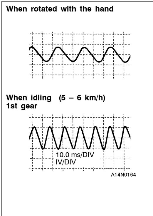
**INSPECTION PROCEDURE USING OSCILLOSCOPE**
