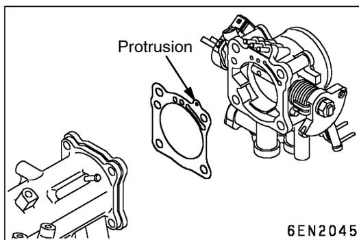
**▶C◀ THROTTLE BODY GASKET INSTALLATION**
