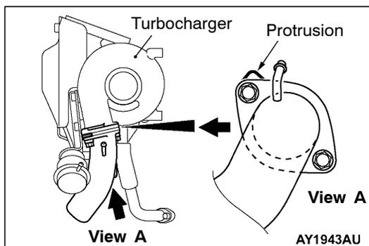
**▶B◀ AIR OUTLET FITTING GASKET INSTALLATION**
