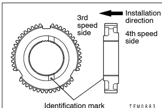
**▶E◀ 3RD-4TH SPEED SYNCHRONIZER HUB INSTALLATION**
