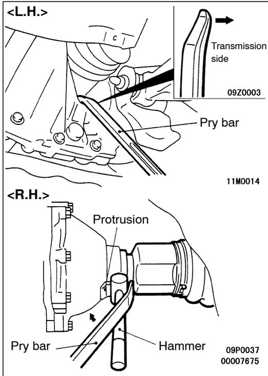
**◀B▶ DRIVE SHAFT <L.H.>/DRIVE SHAFT <R.H.> DISCONNECTION**
