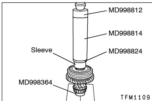
►G◄ 2ND SPEED GEAR SLEEVE INSTALLATION
