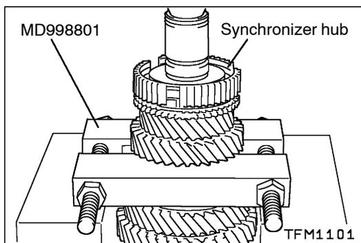
**◀C▶ 5TH-REVERSE SPEED SYNCHRONIZER HUB REMOVAL**
