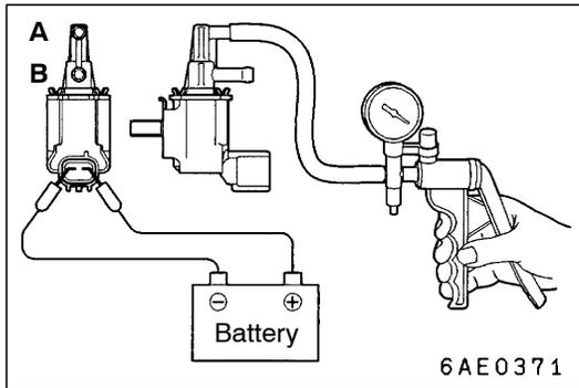
**WASTE GATE SOLENOID VALVE CHECK**
