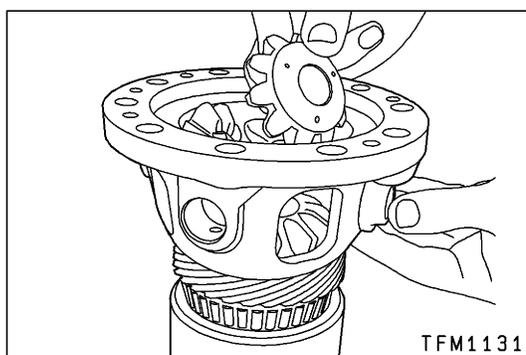
**▶C◀ SPACER/SIDE GEAR/WASHER/PINION/PINION SHAFT HOLDER/PINION SHAFT/LOCK PIN/Front OUTPUT SHAFT/SNAP RING/CENTER DIFFERENTIAL FLANGE INSTALLATION**
