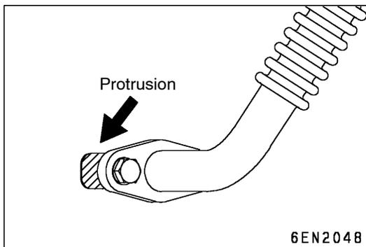
**►B◄ OIL RETURN PIPE GASKET INSTALLATION**
