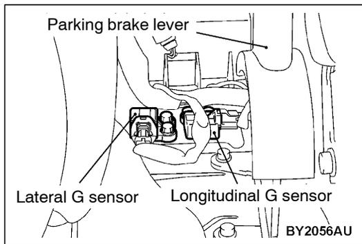
**LATERAL G SENSOR/LONGITUDINAL G SENSOR**
