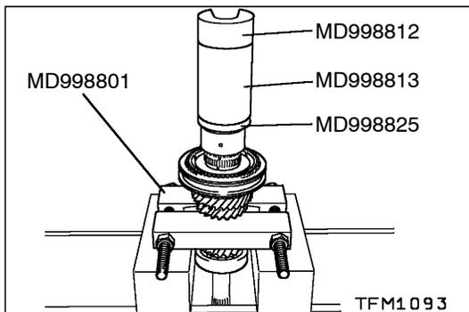
**▶H◀ 4TH SPEED GEAR SLEEVE INSTALLATION**
