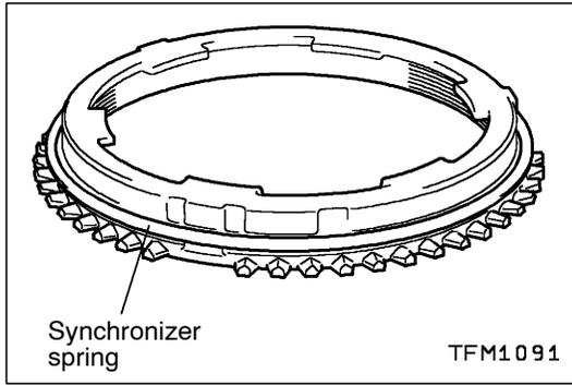
►L◄ SYNCHRONIZER SPRING INSTALLATION
