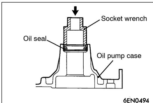
►D◄ OIL PUMP OIL SEAL INSTALLATION
