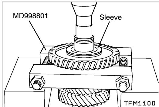
**◀B▶ REVERSE GEAR BEARING SLEEVE REMOVAL**
