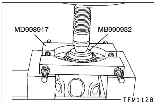
**◀B▶ TAPER ROLLER BEARING REMOVAL**
