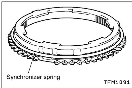
**▶D◀ SYNCHRONIZER SPRING INSTALLATION**
